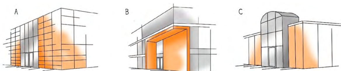
Rysunek 7. Przykład wyróżnienia strefy wejściowej: A – zmiana materiału na elewacji, B – podcień budynku, C – wywyższenie części budynku [rys. Natalia Ratajczak-Szponik]
